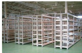
棚同士を連結固定させることで転倒を防ぐ方法。後付で施工でき、アンカー固定が不要の為、簡易的。
