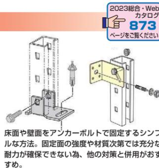
床面や壁面をアンカーボルトで固定するシンプルな方法。固定面の強度や材質次第では十分な耐力が確保できない為、他の対策と併用がおすすめ。
