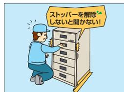
引き手の内側にはストッパーを内蔵しています。引き手を引くだけで自動的にストッパーが外れ、スムーズに引出しが開けられます。移動時や、地震等による引出しの飛び出しや、キャビネットの転倒から収納物を守る装置です。
