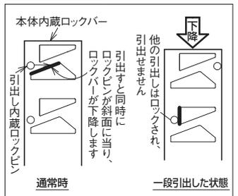
一つの引出しを開けると安全システムが自動的に動いて、他の引出しは全てロックされます。引出しが一段ずつしか開かない為、キャビネットを転倒事故から守ります。
