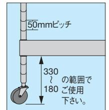
均等耐荷重 **100kg** (2段) 均等耐荷重 **200kg** (3段) **H880mm W750×D500mm**
