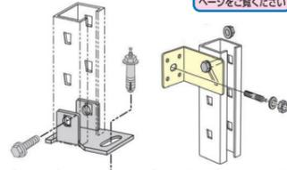
床面や壁面をアンカーボルトで固定するシンプルな方法。固定面の強度や材質次第では十分な耐力が確保できない為、他の対策と併用がおすすめ。
