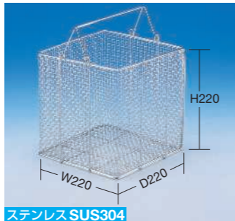
ステンレス SUS304 線径網：0.8mm 線径枠：3mm（単位：mm） 外形寸法 □ 品番 価格（税抜） メーカー希望小売価格 220×220×H220 194618 SS角カゴ220 ¥5,320 ¥7,700 ●網目5.5mm目 ●規定出荷数：12個
