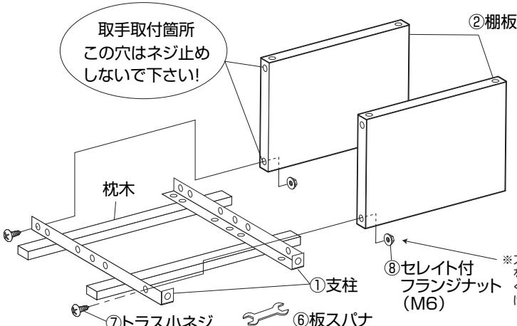
② ①と同じ手順で反対側の支柱を仮止めします。
