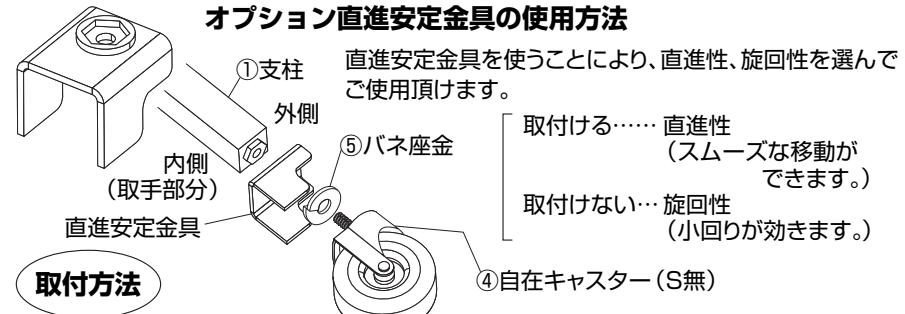
② のキャスター取付けの際に、取手と反対側の2輪に取付けます。
