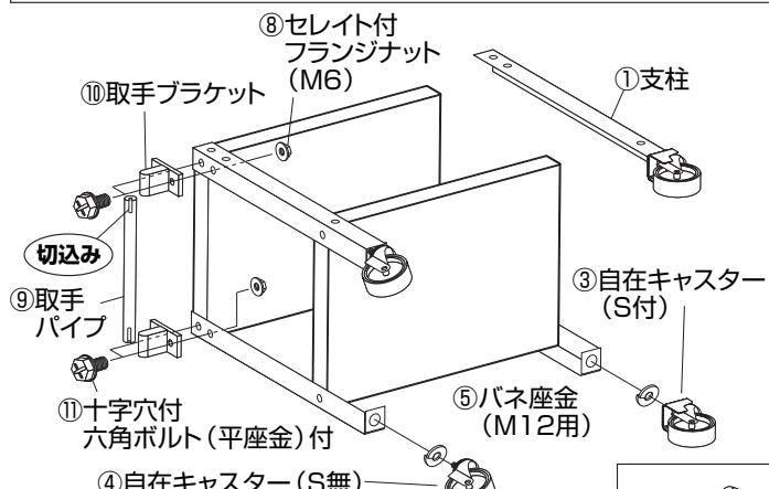
キャスターの取付けは、⑤バネ座金をはめ込み付属のスパナで締め付けます。
