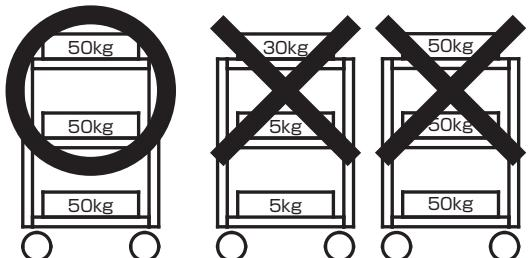
床面は平坦なコンクリートでツールワゴン1台当りの均等耐荷重を棚板の枚数で割った重量を上限に各段均等にお載せ下さい。
